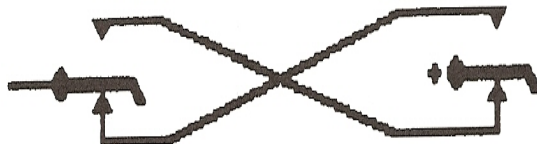
Slika 2: mehanski princip XOR
