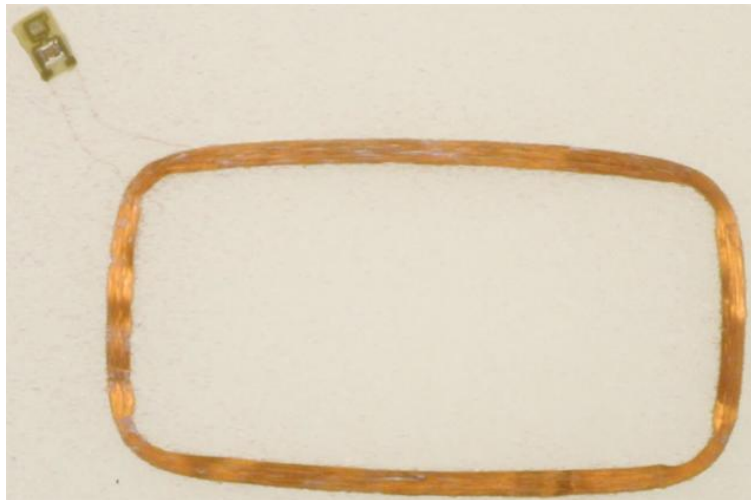
Slika 6: Slika kartice HID Indala FlexCard z odstranjeno zaščito (Vir: [8]). Slika prikazuje induktivno zanko (anteno kartice) povezano na integrirano vezje
