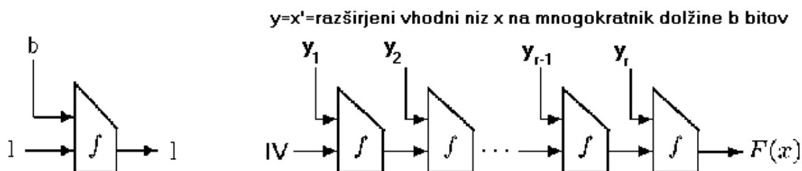
slika 3.1: zgoščevalna funkcija f (levo) in iterativna konstrukcija zgoščevalne funkcije F s povezavo zgoščevalnih funkcij f v verigo (desno)
